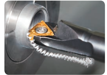
F1 chipbreakers evacuates chips BACKWARD (S-STUC style shown)
